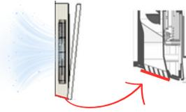
Pour profiter d'un flux d'air en 2D (des deux côtés uniquement), il vous suffit de fermer la grille de protection au bas du climatiseur.
