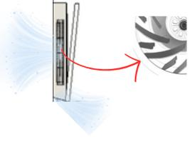
De puissants turbo-ventilateurs diffusent l'air à gauche, à droite et en bas, afin d'obtenir un flux d'air en 3D.
