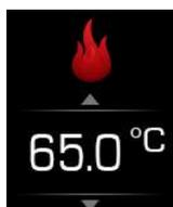
Dans le cas de l'utilisation d'une source externe, il est possible de régler le point de consigne. L'hystérésis de chauffe est fixé à 10 °C.
