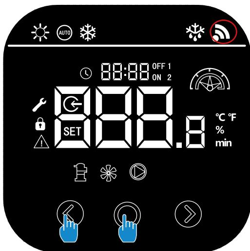
Druk tegelijkertijd 5 seconden op ☰ + ☰ , WiFi knippert snel, de besturingseenheid is klaar om te worden gekoppeld.
