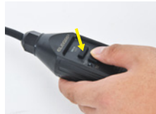
3. Drücken Sie die Test-Taste, die Anzeige erlischt.
