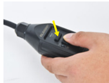
3. Premendo il tasto "TEST", la spia dell'indicatore si spegne.
