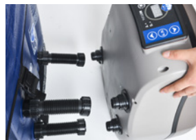
3) Lösen Sie die 3 Anschlüsse vom Motorblock.
