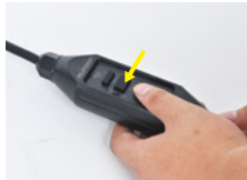
2. Drücken Sie die Reset-Taste, die Anzeige wird rot.
