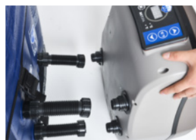
3) Svitare le tre raccordi del blocco motore..
