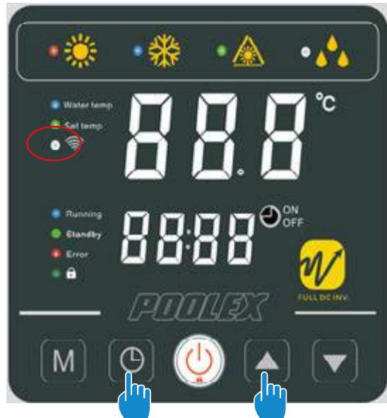
Druk tegelijkertijd 5 seconden op ☰ + ⏪ , WiFi knippert snel, de besturingseenheid is klaar om te worden gekoppeld.
