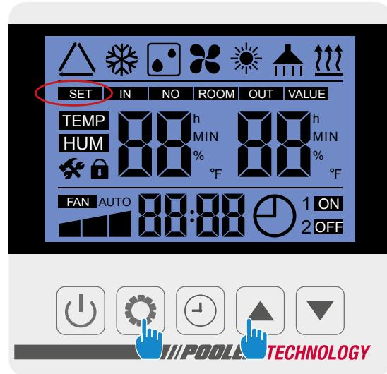
Druk tegelijkertijd 3 seconden op ☰ + ⏪ , SET knippert snel, de besturingseenheid is klaar om te worden gekoppeld.
