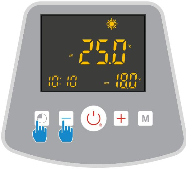
Druk tegelijkertijd 5 seconden op ☰ + ⏪ , WiFi knippert snel, de besturingseenheid is klaar om te worden gekoppeld.
